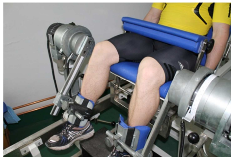
7.1. ábra. Multicont II. típusú, számítógép vezérlésű dinamométer a térd extensor izmainak vizsgálatára.
