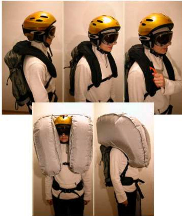
6/3 kép: A lavina légszak működése. Lavina észlelésekor a fogantyú meghúzása működésbe hozza a zsákot robbanásszerűen felfújó oxigénpatront
