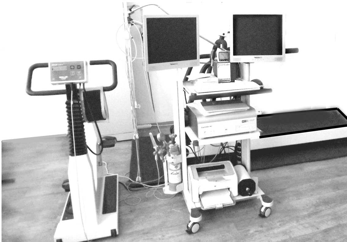
42. ábra: Kerékpár- és futószalag-ergométeres terheléses vizsgálatokhoz alkalmas computer-asszisztált mérőrendszer
